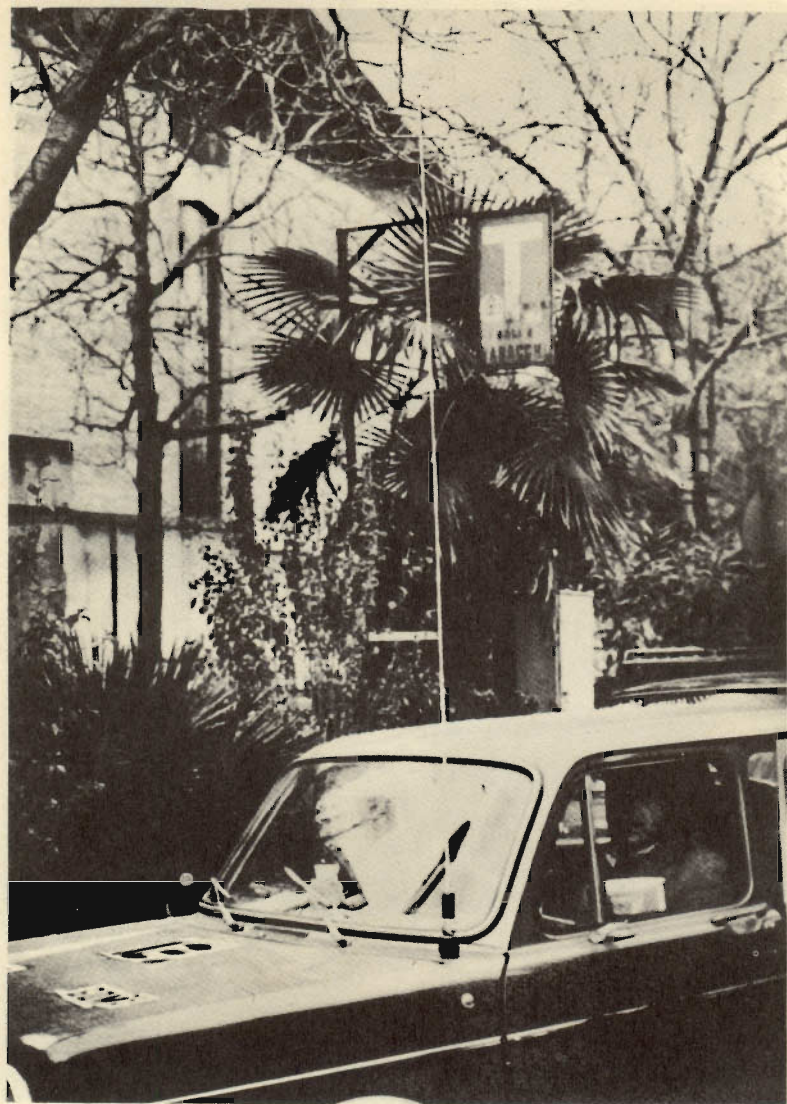
Ancoraggio sul lato anteriore: valido solo per vetture con motore posteriore.
